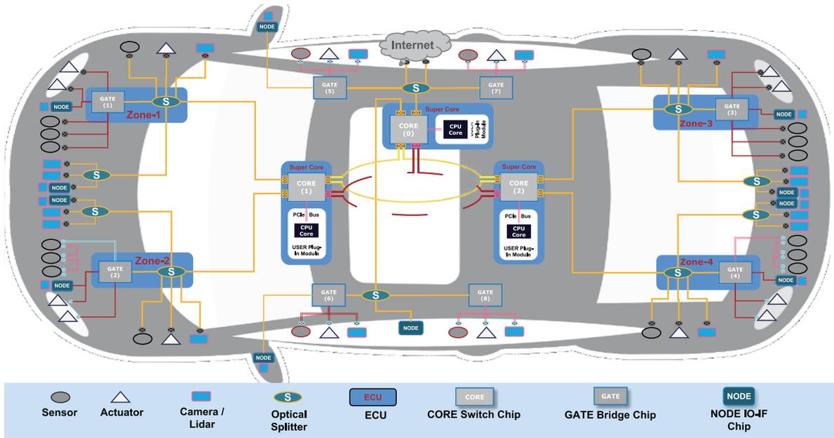
新一代的汽车电子电气架构是基于区架构+集中计算，需要带宽高、稳定可靠、冗余保护、低时延、确定性的车上骨干网络；智能驾驶，对车载摄像头和雷达有更多依赖，基于TS-PON的环网光纤骨干网络能提供极低时延的高带宽通信能力且支持冗余备份保护的全车光网络，实现ADAS和Infotainment 统一接入并提供高可靠保护体系。
